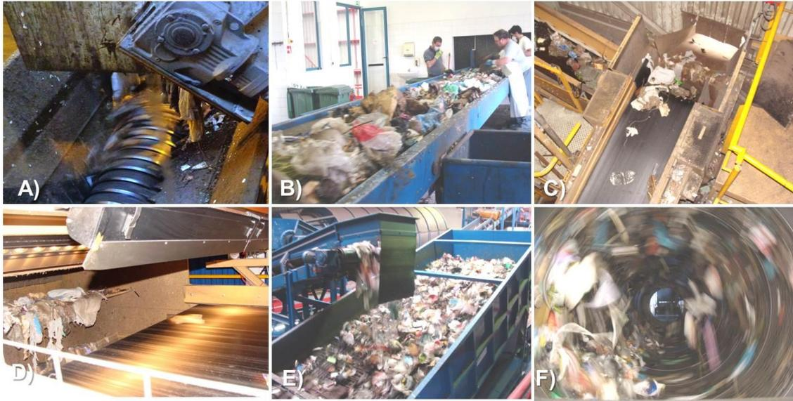
**Fig. 2-2 – Alguns processos e equipamentos usados usualmente no Pré-Tratamento Mecânico: A) Abresacos B) Cabine de triagem manual C) Separador por correntes de *Foucault* D) Triador óptico E) Separador Balístico F) Crivo rotativo**
