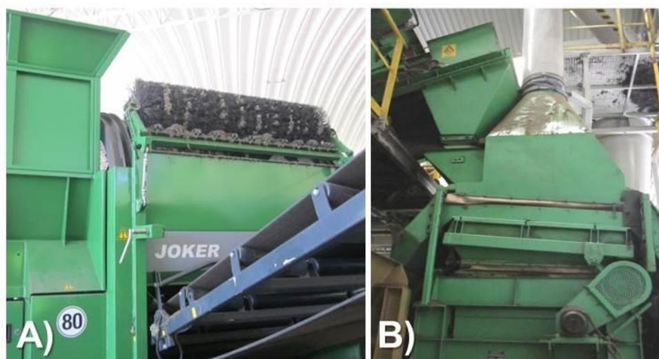
**Fig. 2-4 - Alguns processos e equipamento usados usualmente na afinação: A) Crivo B) Mesa densimétrica**
