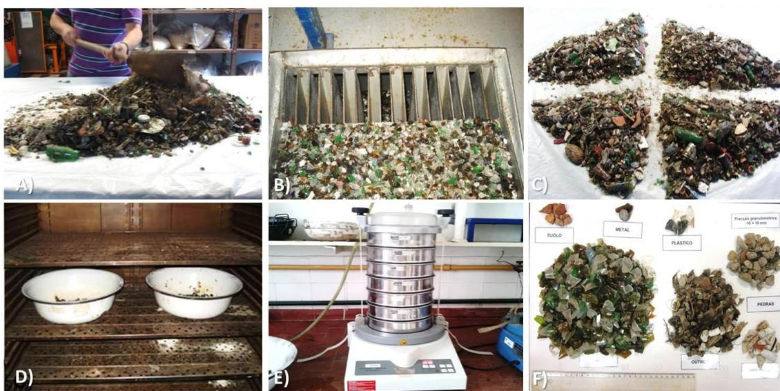
**Fig. 3-1 – Preparação das amostras. A) Homogeneização. B) Divisão no divisor Jones. C) Divisão por quartejamento. D) Secagem na estufa. E) Crivagem mecânica. F) Análise de composição manual.**
