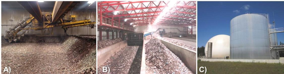
**Fig. 2-3 - Processos e equipamento usados usualmente no tratamento biológico: A) Compostagem em túneis B) Compostagem em silos C) Digestor à direita e gasómetro à esquerda**
